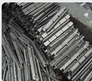
Ghi lò - Gang chịu nhiệt FGrate - Heat-resistant cast iron
