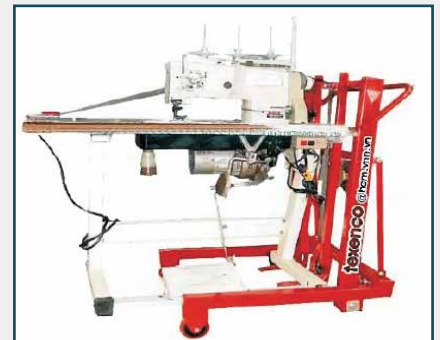
Xe vận chuyển máy may Industrial Sewing Machine Carrier
